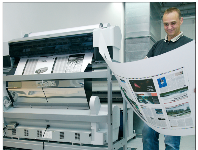
Der Preproofer produziert beidseitig bedruckte Formproofs ohne Wendeeinheit. Das macht ihn für Urs Staudacher auch konzeptionell zur überzeugendsten Lösung.
